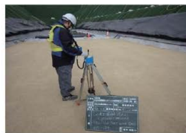
●カスボルによる簡易支持力測定状況
