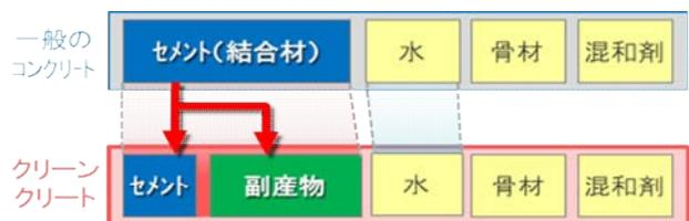
図3 クリーンクリートの材料構成
