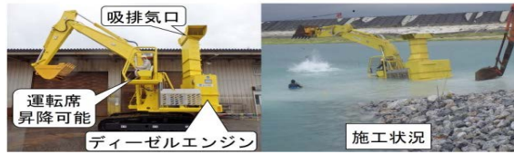
動力ユニットの交換イメージと水陸両用バックホウ
