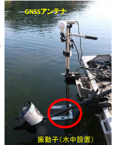
図一2 魚群探知機(本体・振動子)と艀装例
