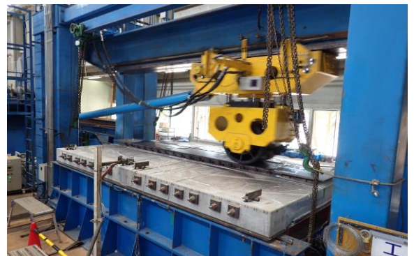
写真3 輪荷重走行試験の様子
