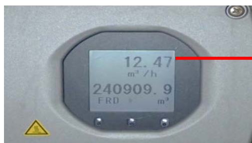
図7: 洗浄前後流量比較例 (12.47m 3 /h→16.02m 3 /hに回復)
