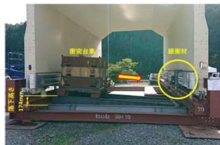
衝突荷重載荷試験
