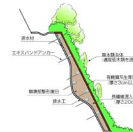
擁壁タイプ(崩壊部復旧タイプ)
