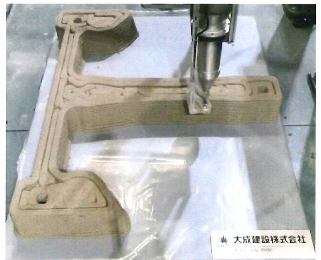
「T-3DP」による部材製作状況
