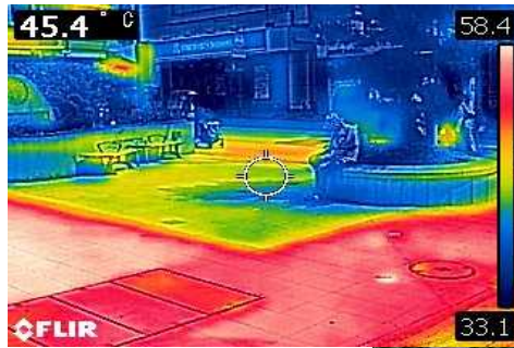
図-2 下水熱利用システム (採熱部の施工例)
