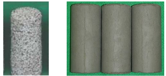
図-4 耐酸性試験後供試体写真
