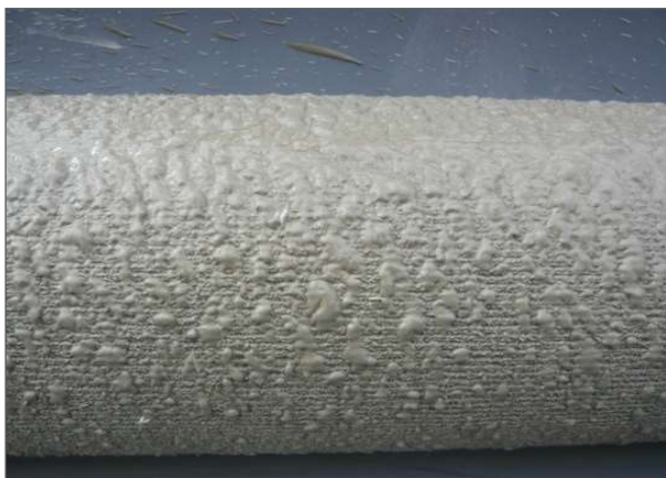
図-4 注入後のパッカー表面
