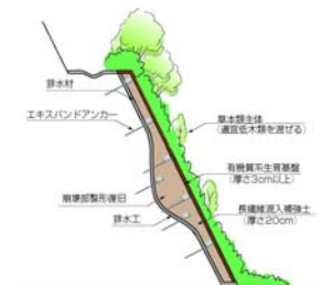
擁壁タイプ(崩壊部復旧タイプ)
