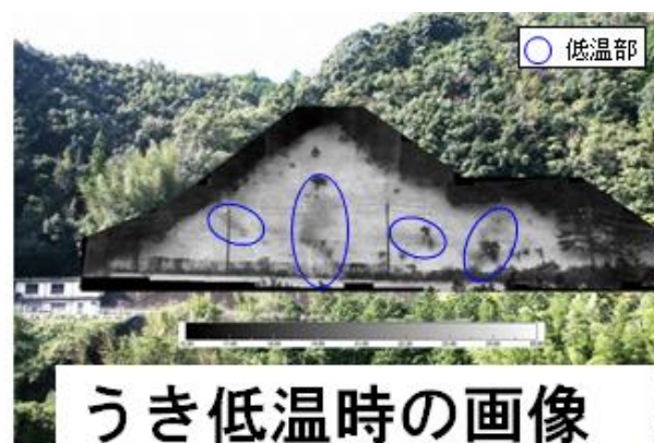
図-2 浮き撮影例(橋梁床版下面)
