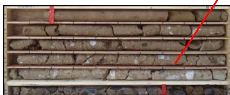
改良体出来形およびボーリングコア
