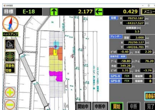
施工管理装置表示例(ICT施工用)
