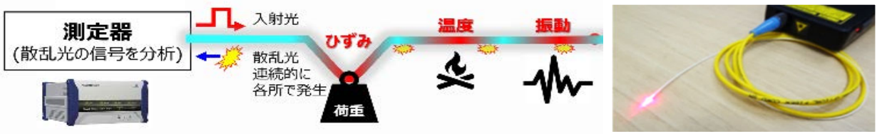
図一 光ファイバによる計測技術の原理
