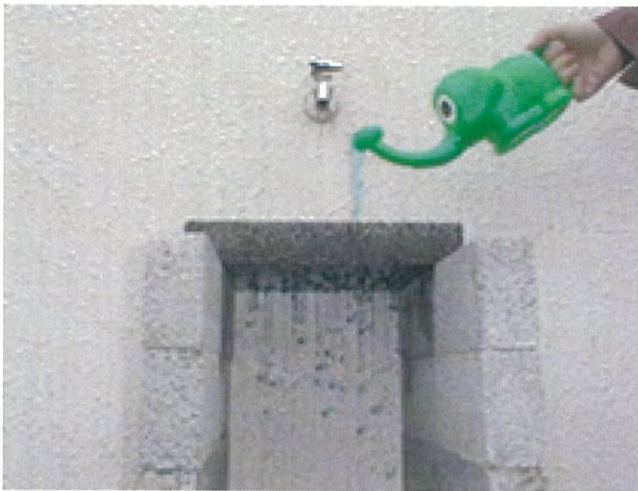
透水くん II を使用したコンクリートの透水状況
