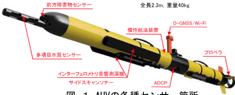
図-1. AUVの各種センサー箇所
