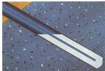
2. グラウト注入 注入パイプを挿入してグラウトを注入します。
