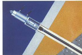
5. 緊張 グラウトが所定の強度に達した所で、緊張作業を行います。プレート背面防食のために、ストップパーシースを取付け、緊張力とアンカー頭部の変位を確認しながら緊張作業を行います。
