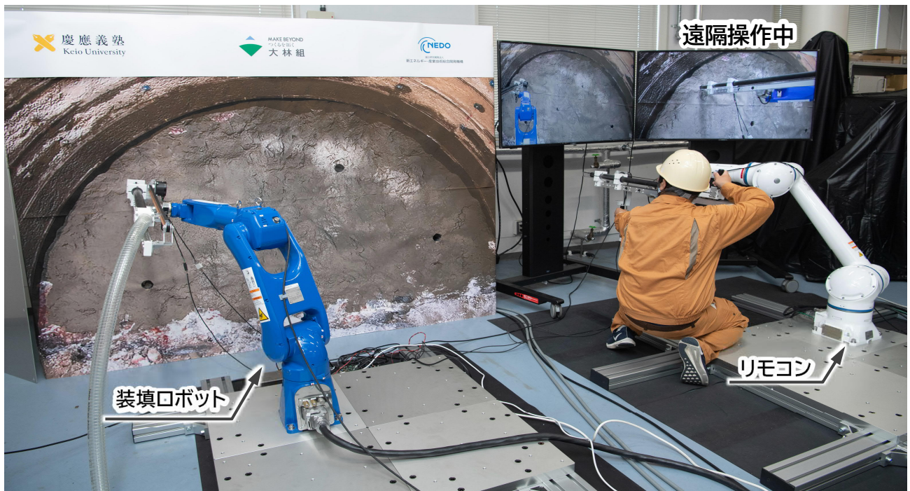
図-2 室内試験 遠隔火薬装填状況
