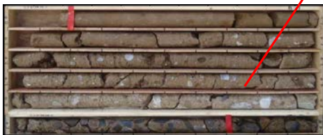
改良体出来形およびボーリングコア
