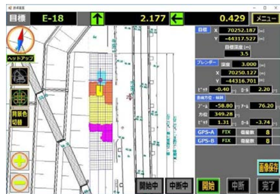
施工管理装置表示例(ICT施工用)
