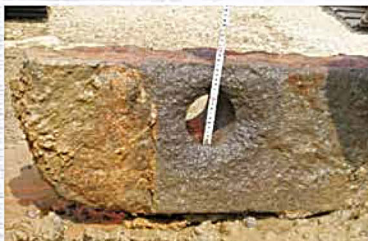
▲「水+硅砂」高圧噴射による障害物削孔
