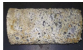
普通コンクリート
