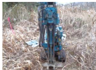
津波堆積物調査(ボーリング)
