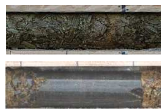
地すべり斜面の破砕岩（上）と、硬質礫・流失しやすい軟質粘性土からなるゆるみ岩盤（下）のコア採取例
