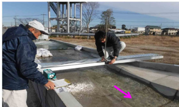
実験状況（流速測定）
