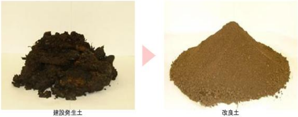
建設発生土と建設発生土改良土(例)
