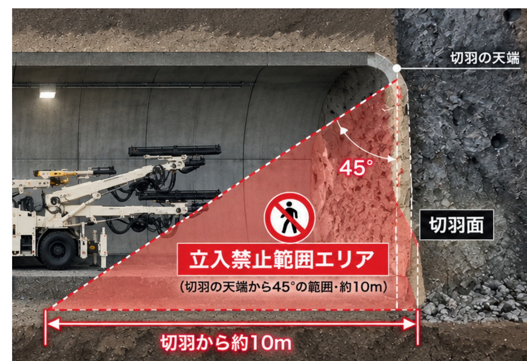
▲トンネル工事 側面断面図（切羽近傍）
