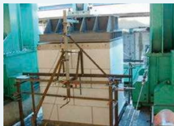
【発泡スチロール土木工法開発機構・JSP】 交通荷重想定鉛直振動実験
