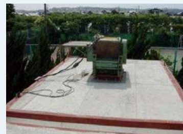
【発泡スチロール土木工法開発機構・JSP】 レベル2地震想定振動実験
