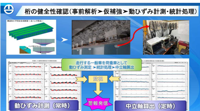
図-1 桁健全性計測システム
