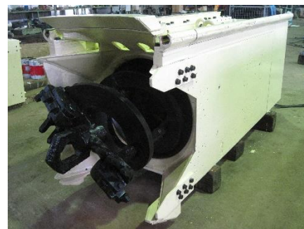
オーガータイプ掘削装置
