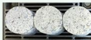
付着強度試験にて 付着強度1.5N/mm 2 以上を確認
