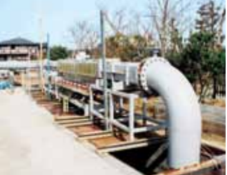
耐流速性試験状況（循環型水路装置）
