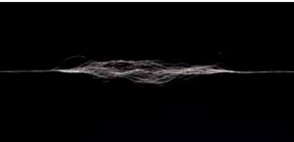
連続繊維補強土に使用する繊維は、ポリエステルフィラメント（連続繊維）を使用しています。
