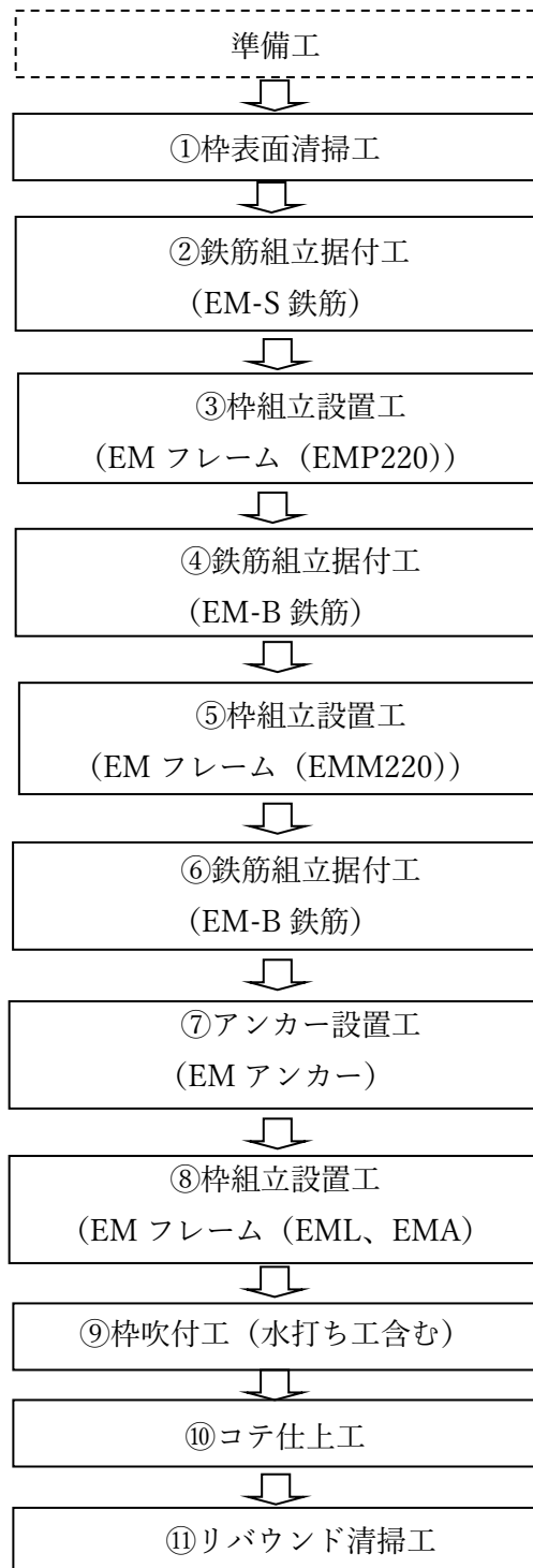
図4-20 のり枠増設タイプ施工フロー
