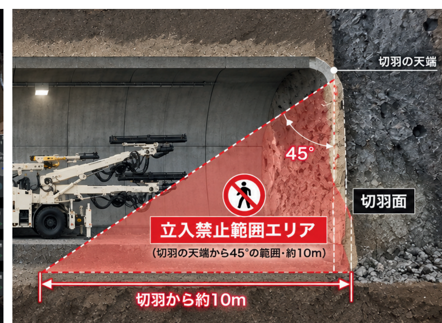
▲トンネル工事 側面断面図（切羽近傍）
