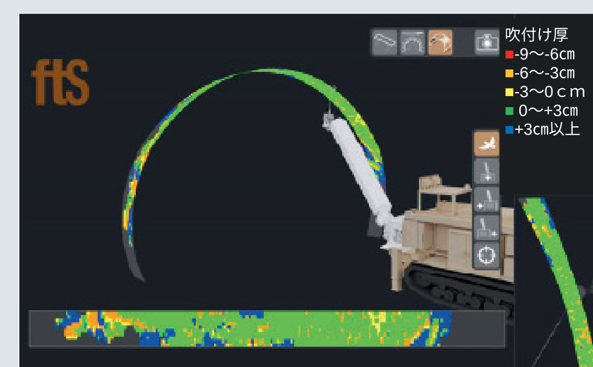
タブレットで吹付けエリアを設定 自動吹付けを開始
