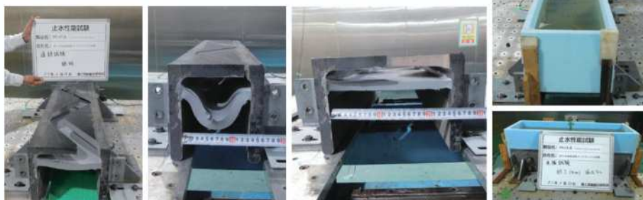
連続試験 圧縮試験 (75mm⇔25mm) 引張試験 (75mm⇔125mm) 水張り試験
