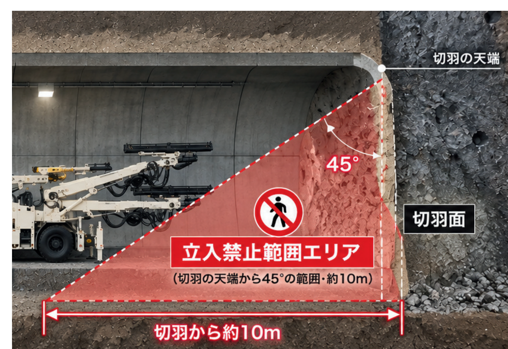
▲トンネル工事 側面断面図（切羽近傍）
