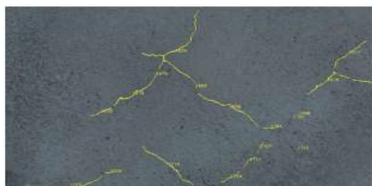
ひびの検出例（0.5mm～1mm）
