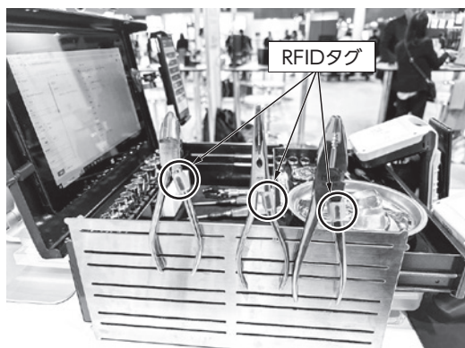
写真1 金属対応した小型のRFIDタグ
