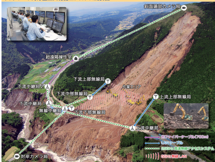
ネットワーク対応型無人化施工システム概要図
