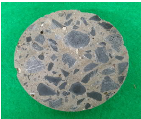
写真1 硬化後のリグニークリート断面
