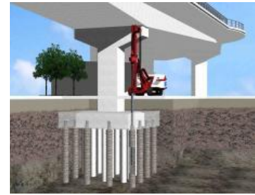
既設構造物基礎の補強増し杭
