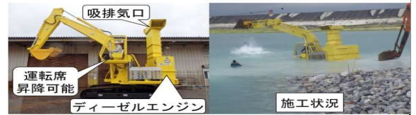
動力ユニットの交換イメージと水陸両用バックホウ
