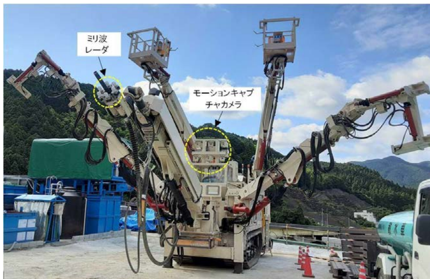
図1 吹付ナビゲーションシステムを搭載した吹付
